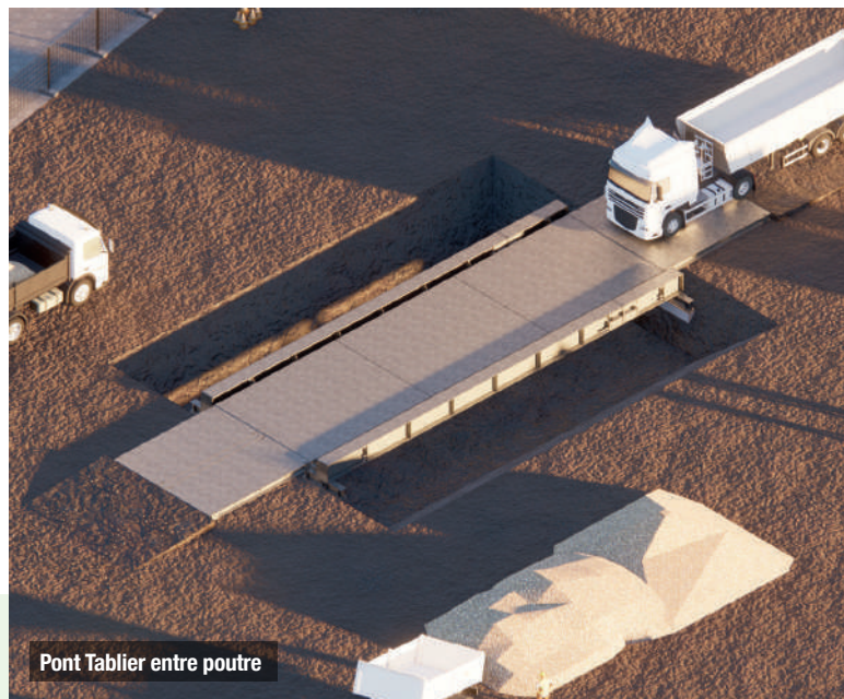
Pont tablier simple
